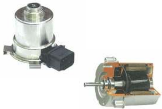
그림61 Actuator[DCT Actuator(좌) / Motor(우)]
