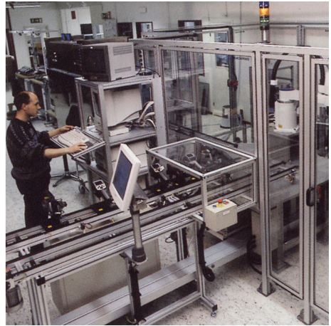
그림 17.5 왼쪽: 기후 조건실에서 적외선 카메라 시험; 오른쪽: 카메라 검사 및 보정 로봇
